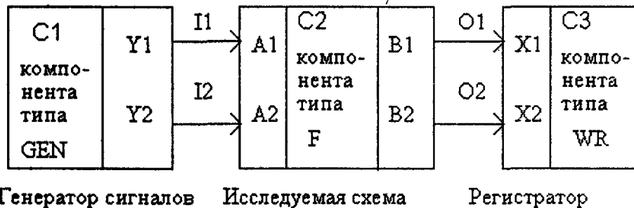
Рис. 4.2. Структура объекта проекта TB_F, реализующего модельный эксперимент по верификации объекта проекта F
